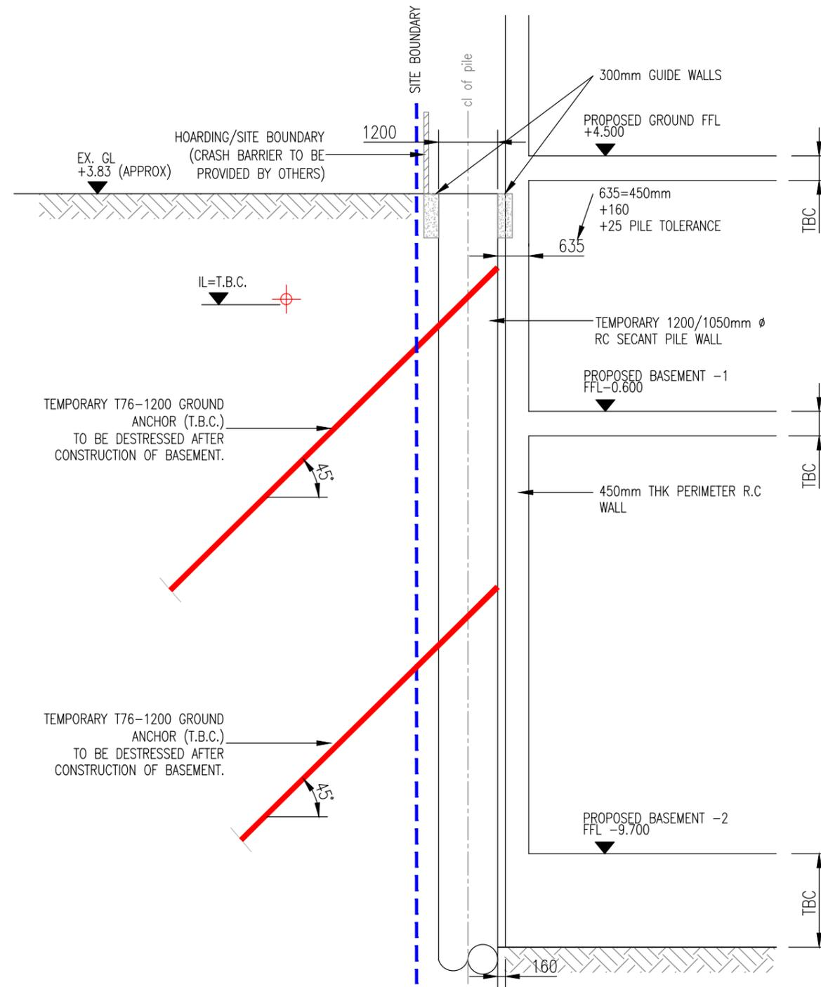
TYPICAL SECANT PILE WALL
